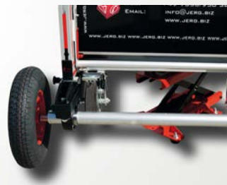
Aufstecken der Lufträder und Absenken
