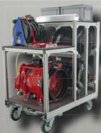
RC-Lüfter (FW Magdeburg)
