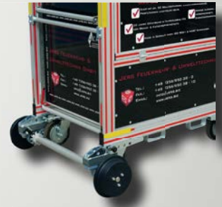
Aufgesteckte Schienenräder an der Bremsseite
