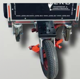
Aufstecken des Lenkrades und Rollcontainer Ablassen
