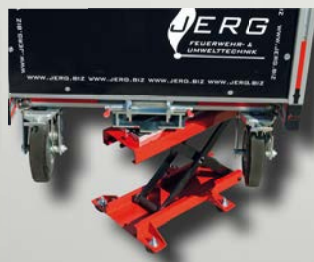
Aufbocken der Lenkradseite mit Wagenheber
